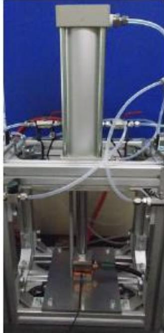
■ 手順・備考：被測定部材を電極間に挟み、一定荷重・一定電流での電極間の電圧差から部材の抵抗を測定する。
