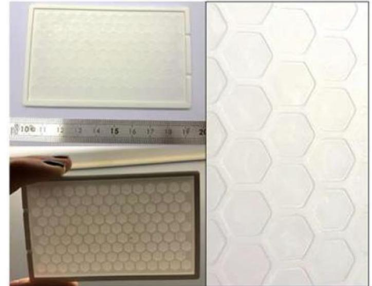
3DプリンターによるSOFC部材製造装置・各部材の原料(インク)の開発
