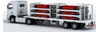
水素輸送トレーラー
