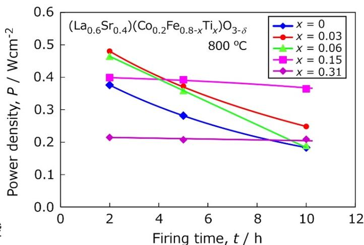
種々の組成のLSCFTを用いた単セル最大出力密度の酸素極焼成時間依存性
