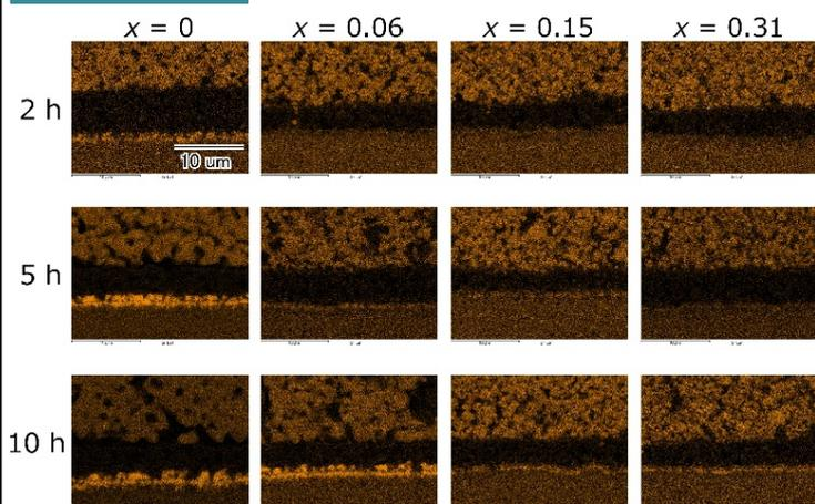
種々の組成のLSCFT酸素極を用いた単セルの酸素極側界面のSEM/EDS分析結果（Sr）
