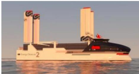
1,450m<sup>2</sup>のOceanwings®を搭載、4MWのFCシステム、1,000m<sup>3</sup>のLH<sub>2</sub>タンクを備えた航続距離は最大4,000海里
