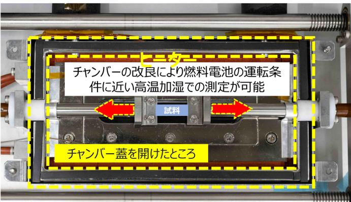
チャンバーの改良により燃料電池の運転条件に近い高温加湿での測定が可能
