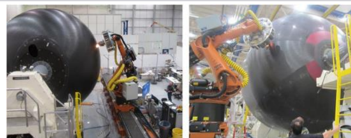
Composite Cryotank Technologies and Demonstration (CCTD) プロジェクトにおけるΦ5.5mクライオタンクのAFP製造
